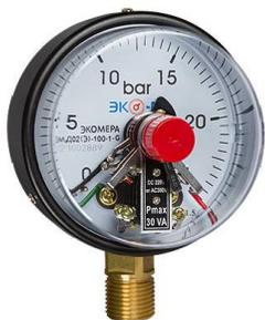
Манометр укомплектован электроконтактами прямого действия с подмагничиванием и подпружиниванием контактных площадок для предотвращения их "дребезга" и подгорная. Контакты покрыты специальным материалом для предотвращения их окисления.
